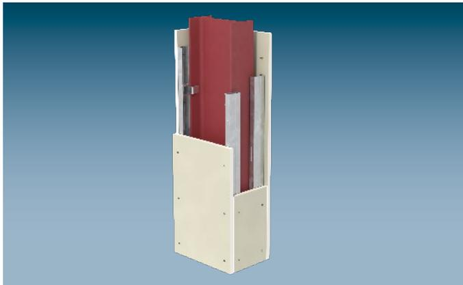
Das System **K253.de** Knauf Fireboard Stahlstützen-Bekleidung wird mit Metallunterkonstruktion und geschraubter Beplankung oder ohne Metallunterkonstruktion und geklammerter Beplankung ausgeführt. Einlagig bis F60 für U/A-Werte  $\leq 300 \text{ m}^{-1}$  möglich.
