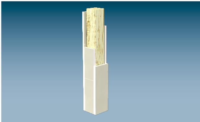
Das System **K255.de** Knauf Fireboard Holzstützen-Bekleidung wird ohne Unterkonstruktion ausgeführt. Die Bekleidung erfolgt durch stirnseitiges Verklammern in den Fireboardplatten.
