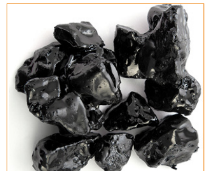
Quarzporphyr behandelt mit Fels Weißkalkhydrat und Bitumen 50-70
